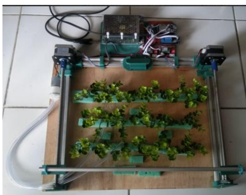
Gambar Keseluruhan Alat Sistem Monitoring Hama Padi
