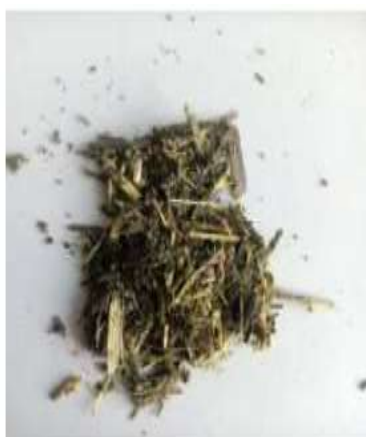
Gambar 5 Hasil Cacahan dengan putaran 1346 rpm
