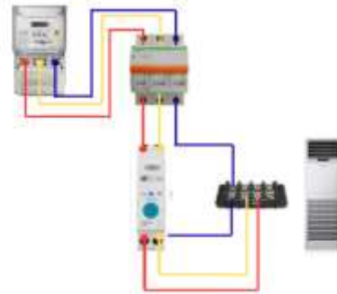
Gambar 1 Design Wiring Diagram Alat Menggunakan Canva
