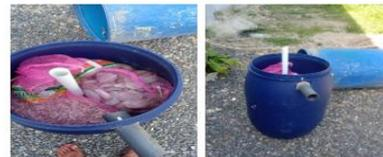
Gambar 3. Drum Sebagai Media Filtrasi Air Kolam Terpal
