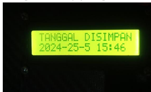
Gambar 8. Fungsi RTC Yang Ditampilkan Di LCD
