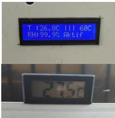
**Gambar 3 Pengukuran Suhu Di Dalam Boks Melalui Termometer Digital**
