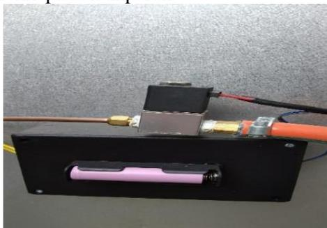
**Gambar 2 *Solenoid Valve* dan Pemantik**
