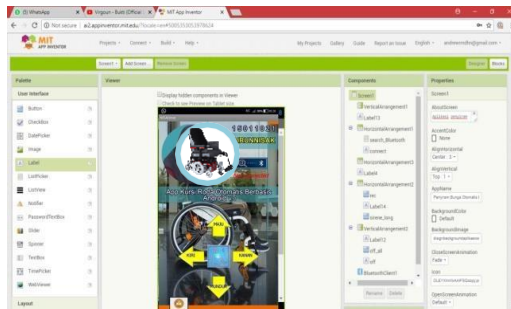
Gambar 2. Design Interface Kursi Roda Otomatis berbasis Android pada Software MIT app Inventor 2
