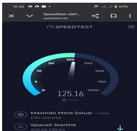
Gambar 2 Hasil uji Throughput unduh pada Starlink
