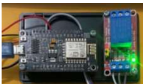
Gambar 3 Pengujian Rangkaian Relay
