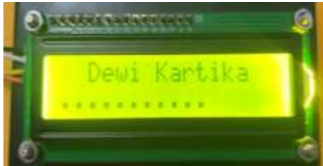
Gambar 2 Pengujian Rangkaian LCD 16x2
