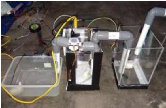
Gambar 4. Alat sistem monitoring kualitas air dan sistem administrasi
