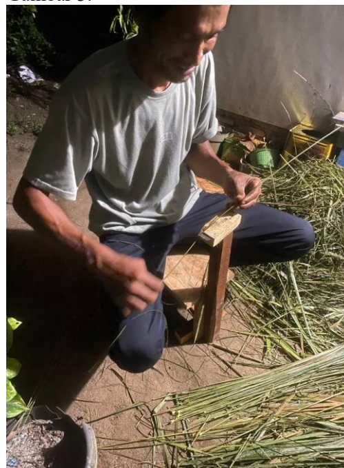
Gambar 3 Cara kerja alat seset lidi saat digunakan
