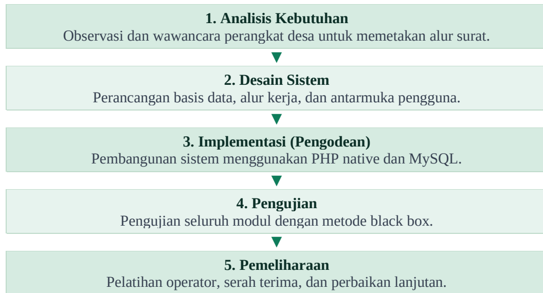
Gambar 1 Tahapan pengembangan sistem dengan model Waterfall
