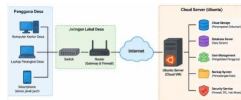
Gambar 2 Rancangan Infrastruktur Server Berbasis Cloud dan Ubuntu
