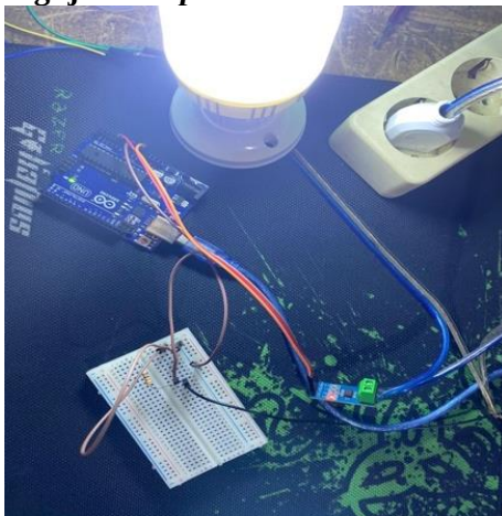
Gambar 3. Pengujian Sensor Arus ACS712
