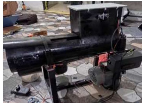
Gambar 2. Mesin Pemisah biji jagung sebelum di evaluasi (wadah penampung jagung terlalu kecil)
