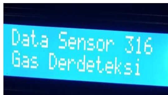
Gambar 7. Kondisi Gas LPG
